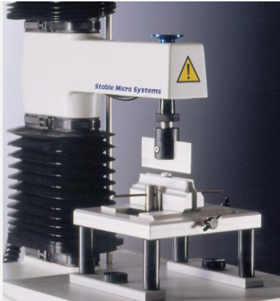
微型三点弯曲测试装置
